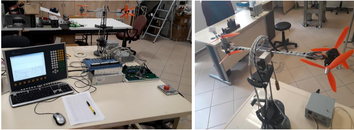
Şekil 2. 2SD dört rotor sistemi çalışma düzeneği
